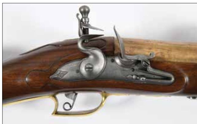
Obr. 12. Granátomet Z 11, detail zapažení křesadlového zámku, stav po restaurování. Foto Eva Řezáčová / Grenade launcher Z 11, detail of installation of the flintlock into the barrel, condition after restoration. Photo Eva Řezáčová
