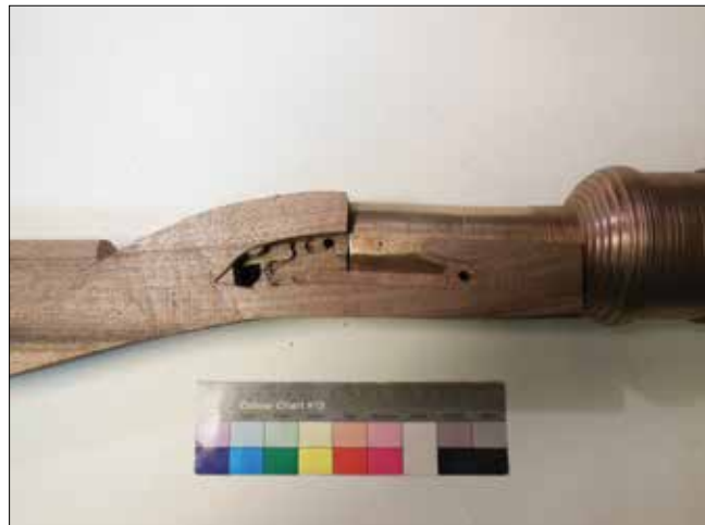
Obr. 10. Průběh zapazbování granátometu Z 11. Foto Petr Vaniček / Progress of installing the grenade launcher barrel Z 11. Photo Petr Vaniček
