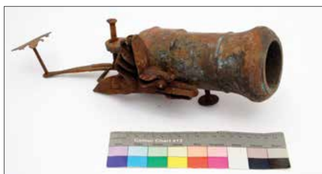
Obr. 6. Granátometná puška Z 56, poškozená hlaveň, stav po požáru. Foto Eva Řezáčová / Grenade launcher Z 56, damaged barrel, condition after fire. Photo Eva Řezáčová
