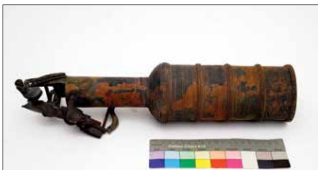
Obr. 3. Granátometná puška Z 11, poškozená hlaveň, stav po požáru. Foto Eva Řezáčová / Grenade launcher Z 11, damaged barrel, condition after the fire. Photo Eva Řezáčová
