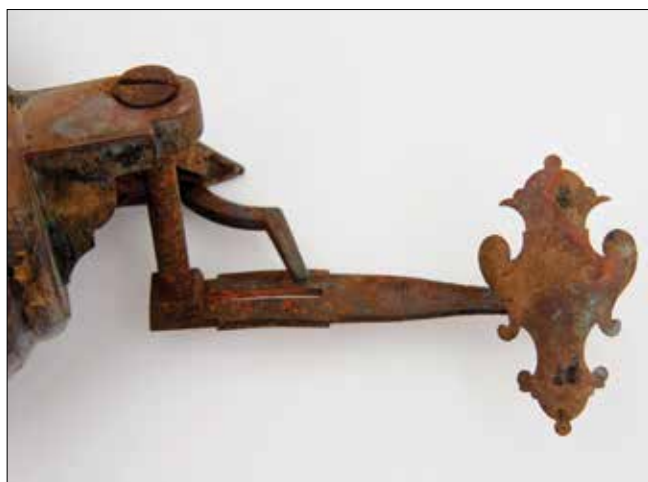
Obr. 7. Granátometná puška Z 56, detail palcového štítku, stav po požáru. Foto Eva Řezáčová / Grenade launcher Z 56, detail of thumb piece, condition after fire. Photo Eva Řezáčová
