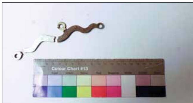
Obr. 5. Granátometná puška Z 11, rozlomená zámková protideska, stav v průběhu čištění. Foto Petr Vaníček / Grenade launcher Z 11, broken backplate of the flintlock, condition during the cleaning. Photo Petr Vaníček
