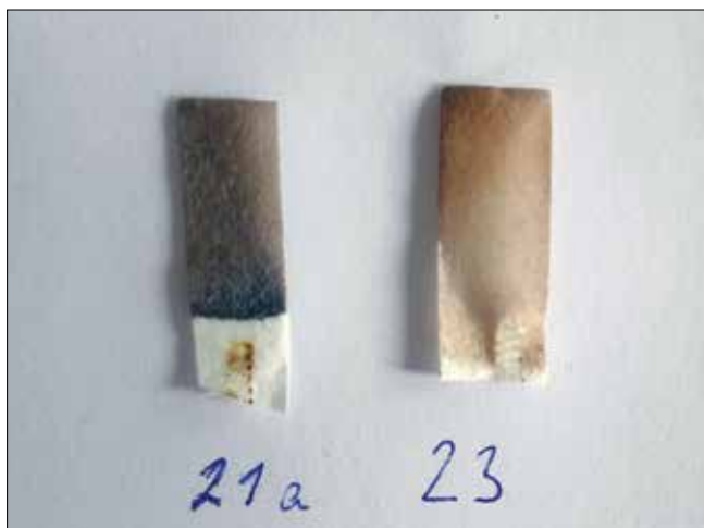
Obr. 13. Důkaz přítomnosti síry v pryži – ztmavnutí octanu olovnatého / Proof for the presence of sulphur in rubber – darkening of lead (II) acetate
