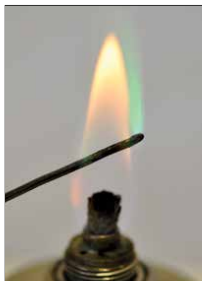
Obr. 10. Důkaz PVC – Beilsteinův test / Proof of PVC – Beilstein test
