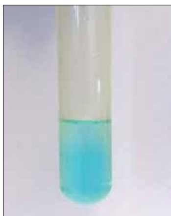
Obr. 11. Důkaz PMMA – reakce s dusitanem sodným / Proof of PMMA – reaction with sodium nitrite
