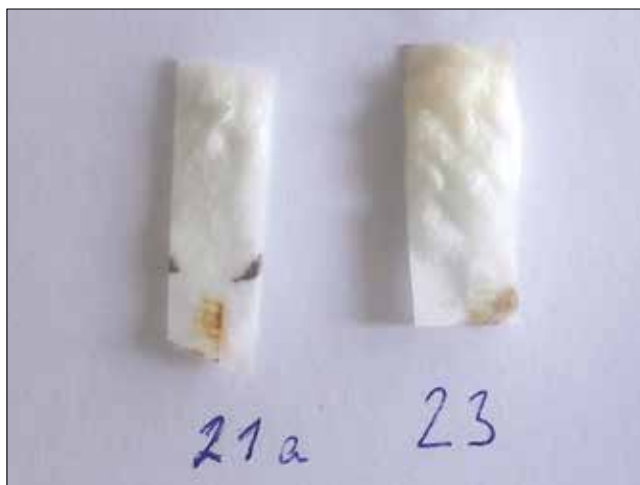
Obr. 14. Doplnující důkaz přítomnosti síry v pryži – odbarvení působením \text{H}_2\text{O}_2 / Supplementary proof for the presence of sulphur in rubber – decolouration through \text{H}_2\text{O}_2
