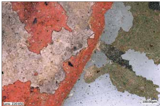
Obr. 1. Mikroskopický snímek poškozených barevných vrstev podmalby sv. Josef (H4-89259) / Microscopic image of damaged colour layers of the reverse painting of Saint Joseph (H4-89259)
