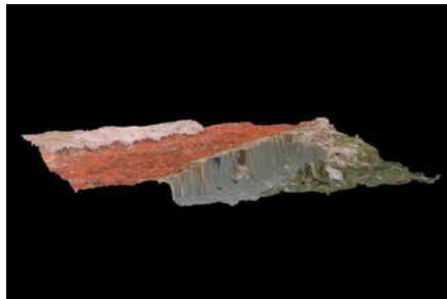
Obr. 2. 3D vizualizace výškového profilu barevných vrstev z Obr. 1 / 3D-visualisation of height profile of colour layers on fig. 1
