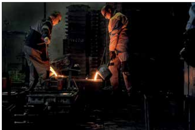
Obr. 5c. Ruční odlévání chybějících kusů firmou Stará Huť s.r.o. do pískových forem v rámech, zdroj: Aleš Svojitka / Manual casting of missing parts by Stará Huť s.r.o. workers into sand molds in frames, source: Aleš Svojitka
