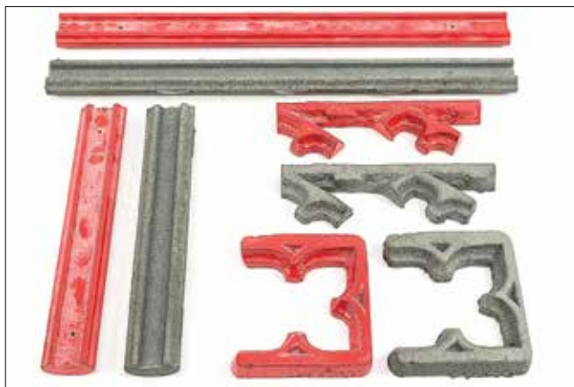
Obr. 5d. Modely zhotovené dle originálu a jejich odlitky po odformování a odříznutí vtokové soustavy / Models and castings after removing from sand molds and cutting off the gating system
