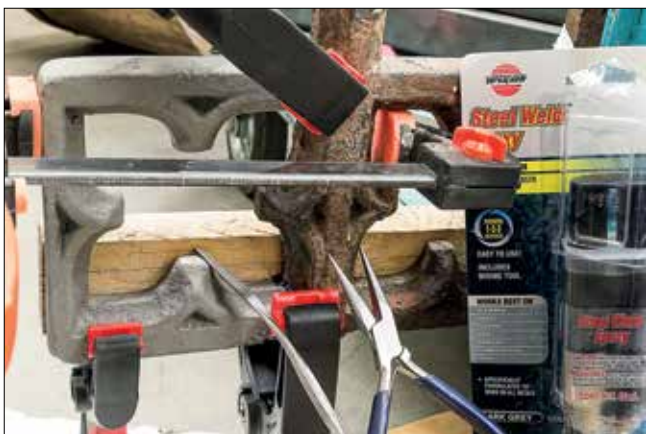
Obr. 5e. Spojení doplněných částí s originálem vysokopevnostním epoxidovým lepidlem / Gluing supplementary parts to the original panel by Steel Weld Epoxy
