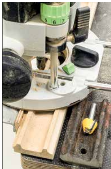
Obr. 5b. Frézování spodního profilu modelu madla podle dochovaného kusu ruční horní frézou stopkovými frézami / Routing the bottom profile of the handle model according to the preserved piece by a plunge router with shaft bits
