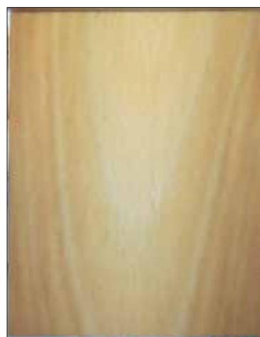
Obr. 3. Průsvit slonovinovou destičkou ukazuje typické žilkování tvořící písmeno V. Fotografie Olga Trmalová / Transmitted light from the back of ivory plate shows typical veining forming letter V. Photo Olga Trmalová
