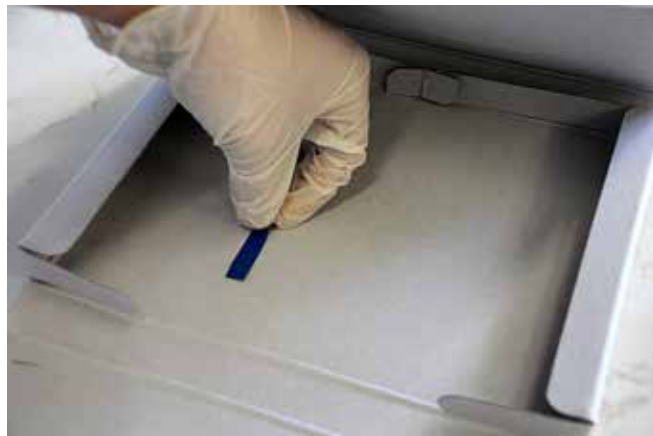
Obr. 2: Testování čistoty prostředí v úložném mobiliáři
