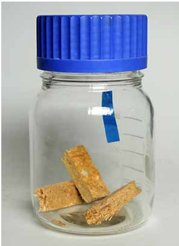
Obr. 3: Testování uvolnění VOC z dřevotřísky
