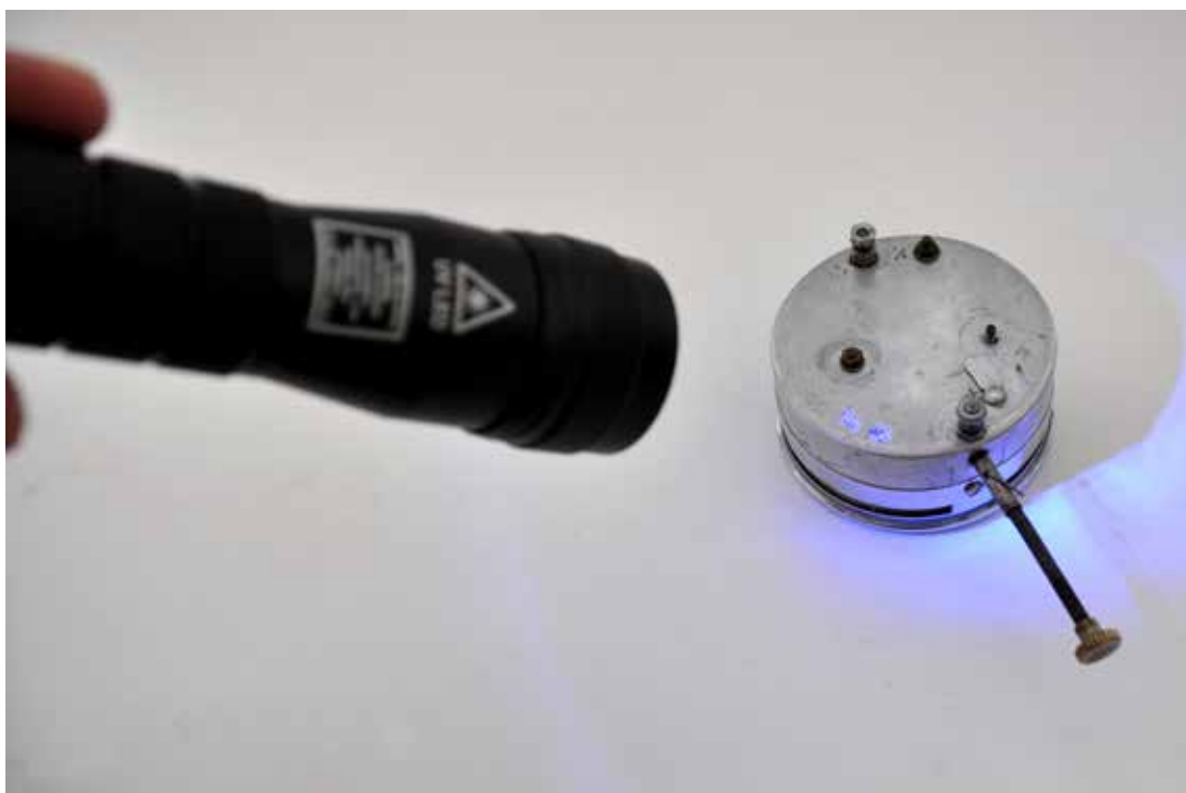
Obr. 4: Nasvětlení předmětu UV světlem, zviditelnění polohy mikroteček s UV citlivým nosičem
