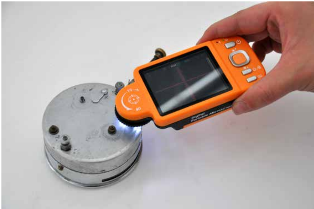
Obr. 6: Fotografický záznam mikrotečky na přenosný kapesní mikroskop
