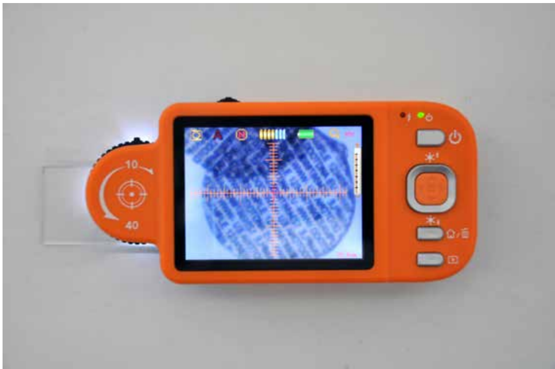
Obr. 7: Zobrazení mikrotečky na kapesním mikroskopu
