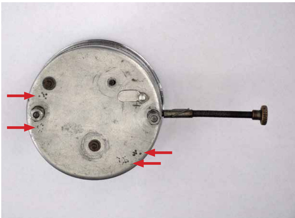
Obr. 3: Mechanické hodiny (zadní nepohledová strana) z automobilu Zbrojovka Z4, po aplikaci nosiče (dodaný výrobcem, citlivý na UV záření) s mikrotečkami dvou velikostí; poloha mikroteček označena šipkami.
