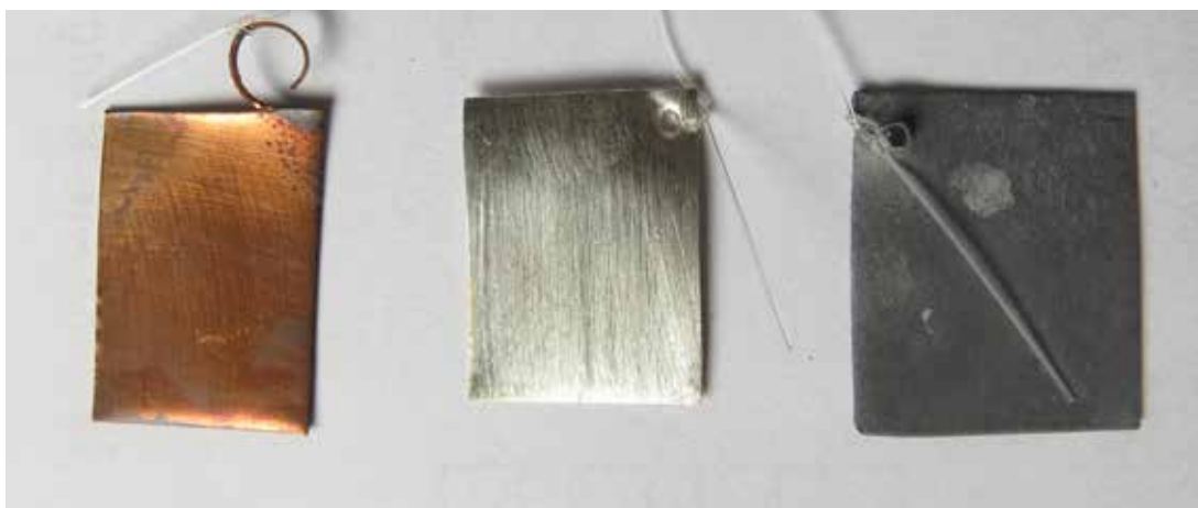
Obr. 8: Kupony po expozici v atmosféře polutantů uvolňujících se z nosiče
