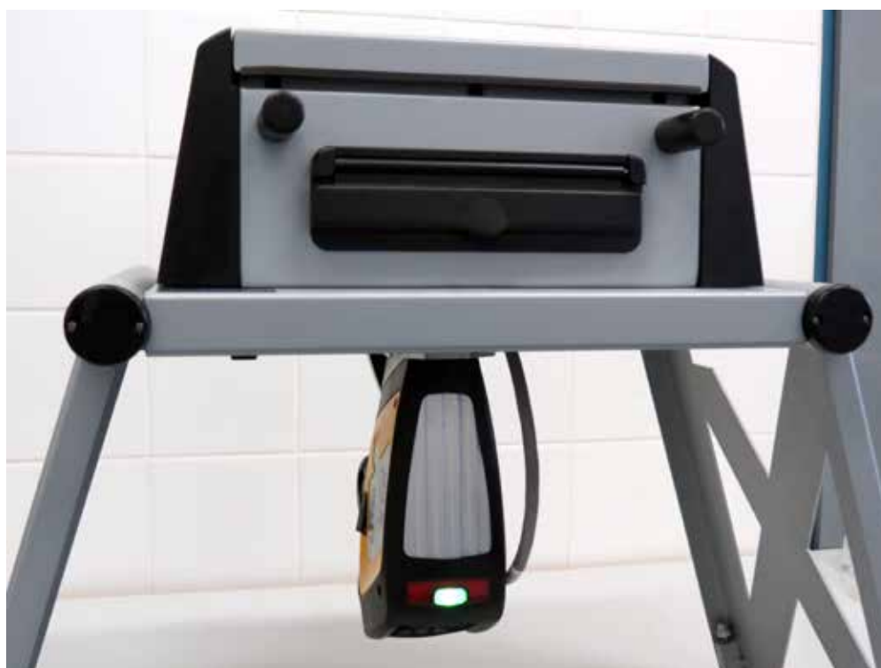
Obr. 2. Měření mobilním XRF spektrometrem pomocí analytického stativu
