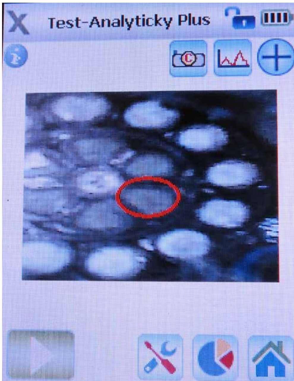
Obr. 9: Měření chemického složení smaltu na stříbrném podkladu se zaměřením plochy na displeji přístroje (čas měření: 60 sekund)
