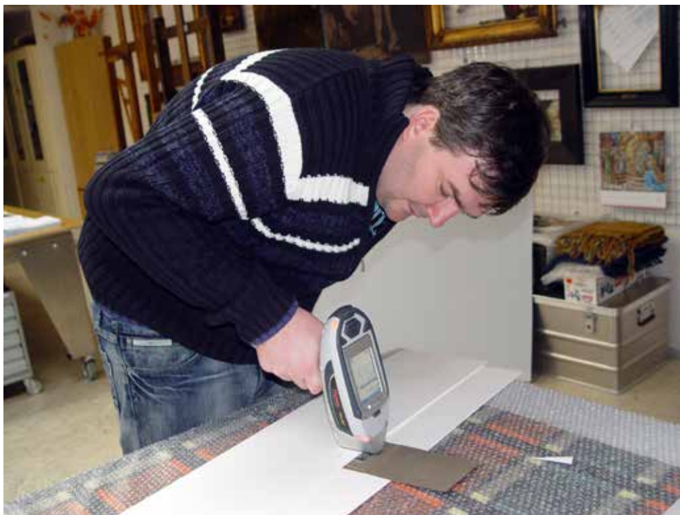
Obr. 1: Měření mobilním XRF spektrometrem v restaurátorských atelierech (Moravská galerie v Brně)
