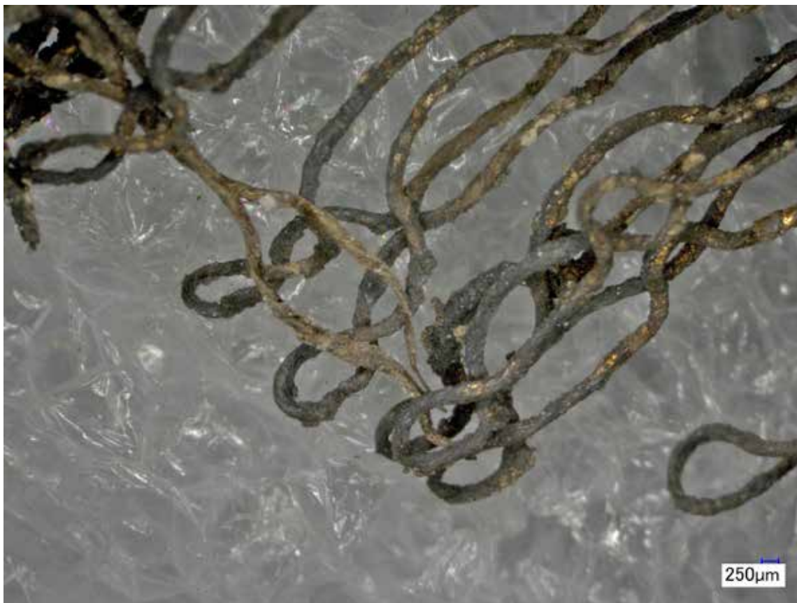
Obr. 12: Brno – Mečová. Kovové středověké nitě, lokálně lze pozorovat reliktů zlcení. Ukázka problematického vzorku - velmi tenký materiál s nepravidelnou geometrií
