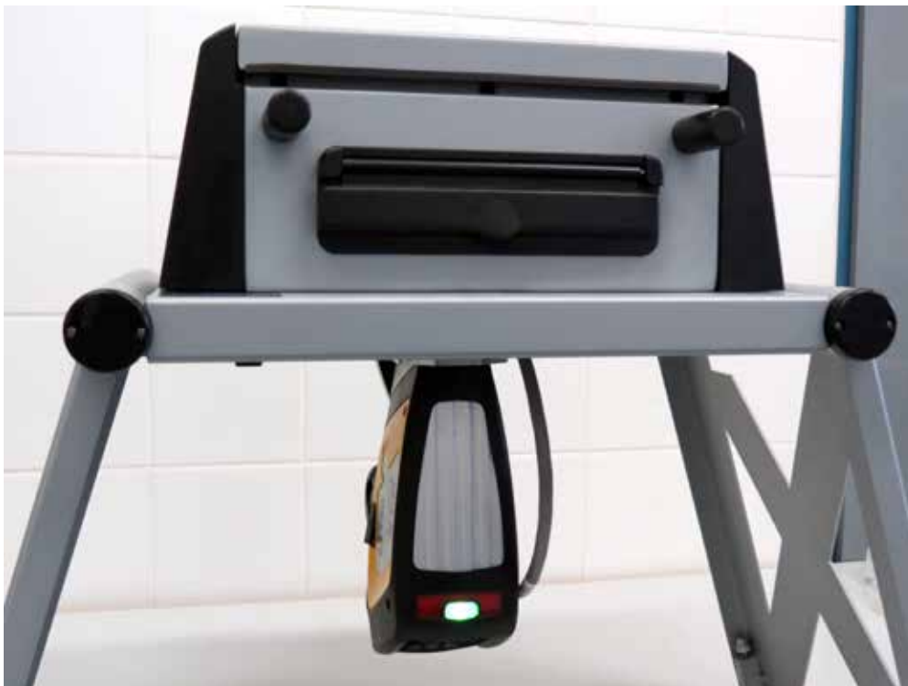
Obr. 2. Měření mobilním XRF spektrometrem v ochranné kabině
