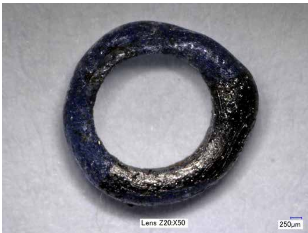
Obr. 9: Brno – Mečová. Kovové středověké nitě, lokálně lze pozorovat reliktů zlacení. Ukázka problematického vzorku - velmi tenký materiál s nepravidelnou geometrií.
