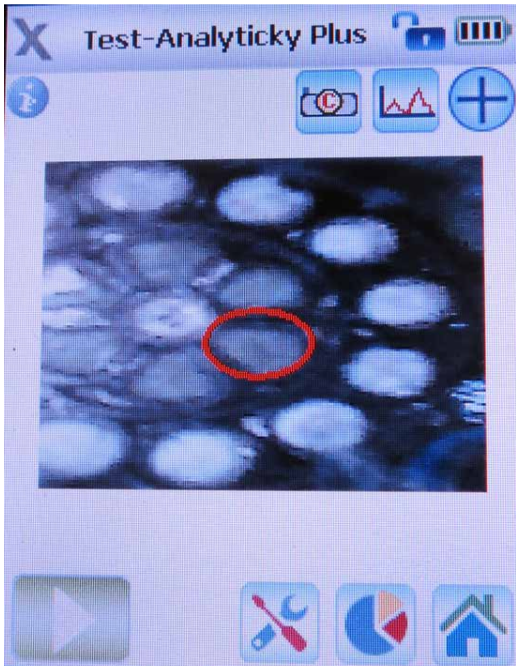
Obr. 8.: Měření chemického složení smaltu na stříbrném podkladu se zaměřením plochy na displeji přístroje
