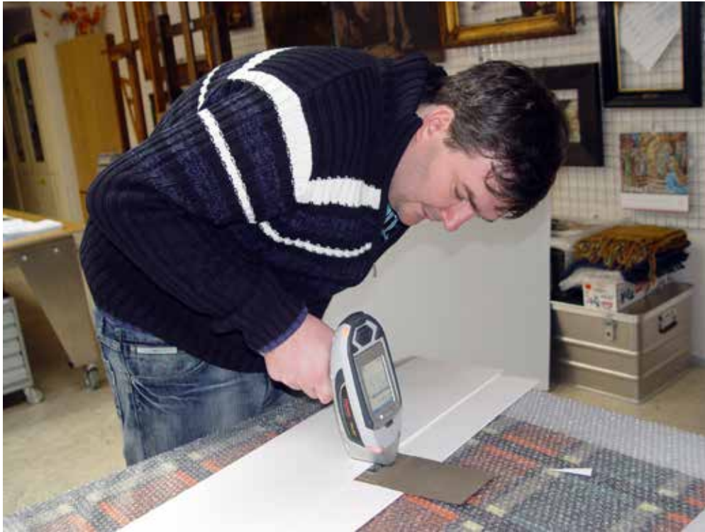
Obr. 1: Měření mobilním XRF spektrometrem přímo na povrchu zkoumaného objektu (Moravská galerie v Brně)
