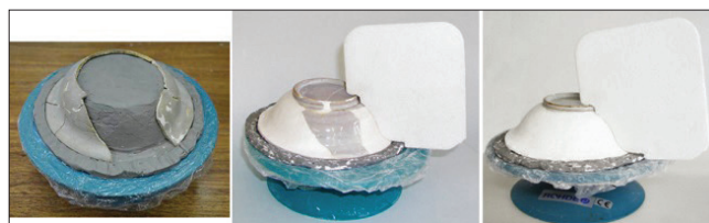
Obr. 5 Kopyto vytvarované dle vnitřních ploch šálku a postupné nanášení sádrové suspenze
