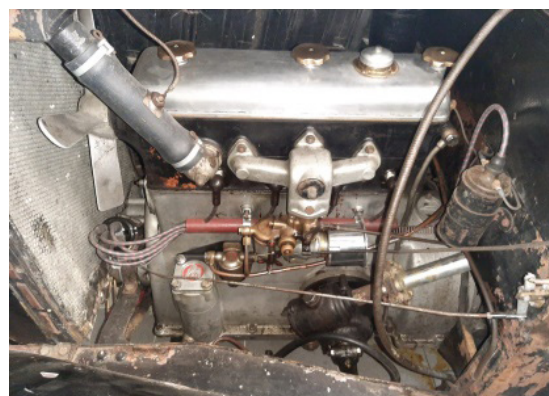
Obr. 4 Motor a původní karburátor / Engine and original carburettor
