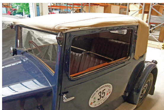
Obr. 20 Nepůvodní střecha / Non-original roof
