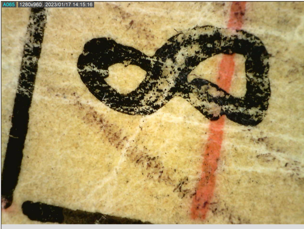
Obr. 4 Detail, USB mikroskop, pozorování poškození záznamových prostředků, avers, transparentní papír inv. č. 13.90-00162 ©Technické muzeum v Brně
