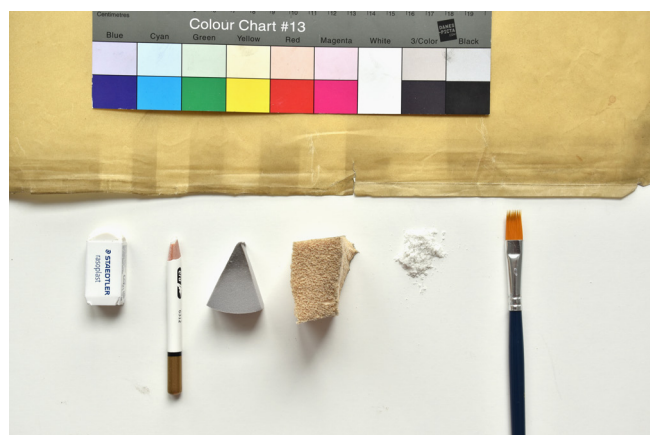
Obr. 5 Srovnání efektivity čištění transparentního papíru různými druhy použitých metod, sondy s přiloženým čistícím materiálem. Zleva doprava: tuhá pryž Staedtler, pryž v tužce KOH-I-NOOR, jemná polyuretanová houbička, Cleanmaster pryž, čistící prášek Wishab aplikovaný štětcem, jemný vlasový štětec / Comparison of the efficiency of cleaning tracing paper by different methods, probes with attached cleaning material. From left to right: Staedtler hard eraser, eraser in a KOH-I-NOOR pencil, soft polyurethane sponge, Cleanmaster eraser, Wishab cleaning powder applied with a brush, fine hair brush
