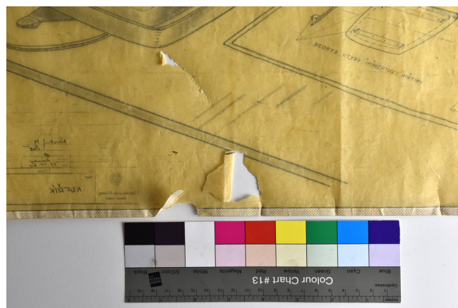
Obr. 1 Mechanické poškození a zkřehnutí okraje výkresu, detail v ostrém bočním nasvícení, revers, transparentní papír, inv. č. 21.19-00001 / Mechanical damage and brittleness of the edge of the drawing, detail in sharp side lighting, reverse, tracing paper, inv. no. 21.19-00001
