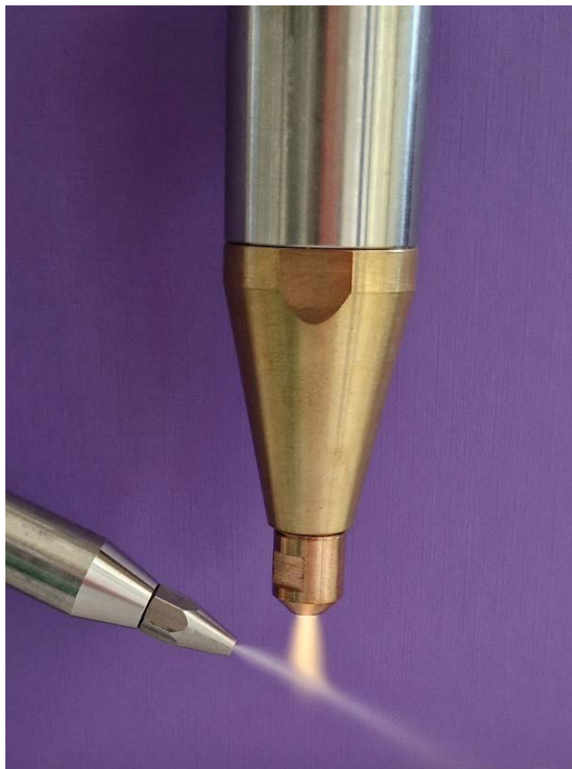
Obr. 1 Mísení proudu plazmatu a dvoufázového spreje / Mixing of plasma stream and two-phase spray
