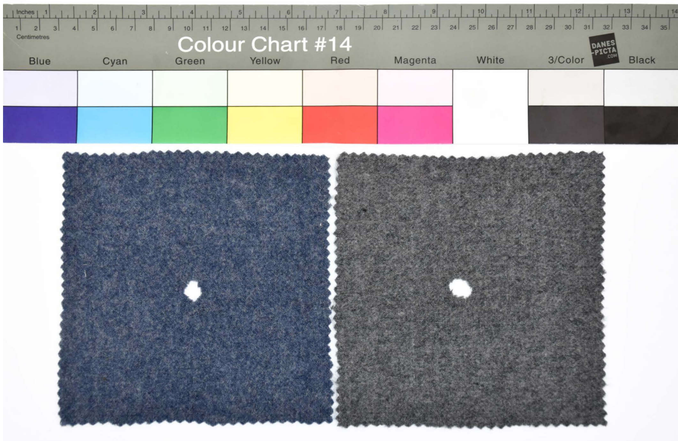
Obr. 6 Zkušební vzorky vlněných tkanin s vytvořenou perforací: vlněné sukno v keprové vazbě modré melange, gramáž 660 g/m 2 (vlevo) a šedé sukno, gramáž 330 g/m 2 (vpravo). Foto © TMB / Test samples of woollen fabrics with perforations: woollen cloth in twill weave of blue melange, weight 660 g/m 2 (left) and grey cloth, weight 330 g/m 2 (right). Photo © TMB
